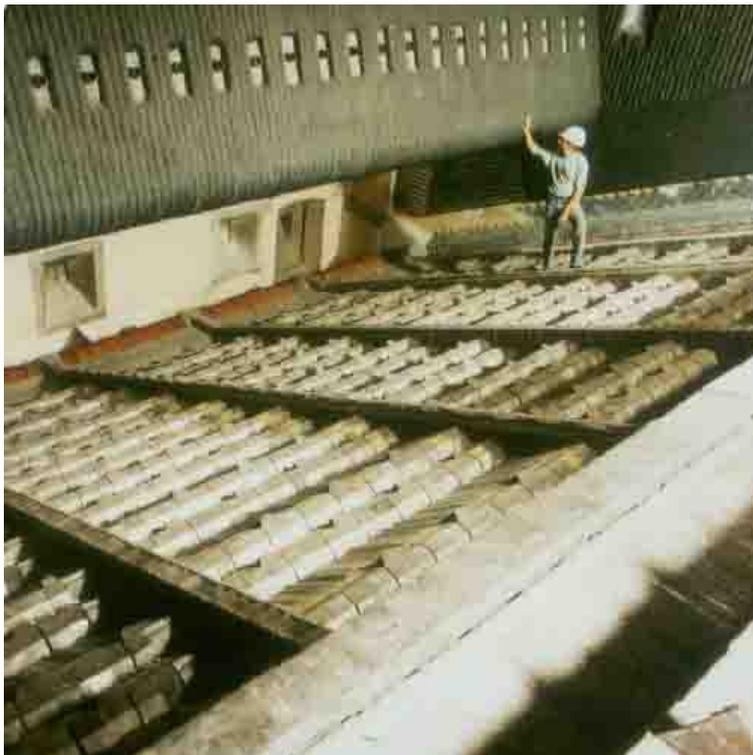
**Fig.6: Foto delle griglie a spinta inversa tecnologia Martin**
