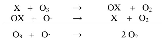
La terza riga riporta il bilancio complessivo della somma delle due prime reazioni. Nella prima reazione la molecola X riesce a strappare un atomo di ossigeno all'Ozono, mentre nella seconda reazione c'è bisogno di un atomo di ossigeno per produrre ossigeno molecolare, con la liberazione della molecola X. Questa seconda reazione sarà perciò favorita nella parte superiore della
